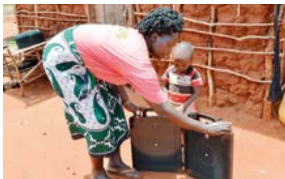
Solvatten är en kombinerad vattenrenare och vattenvärmare.
